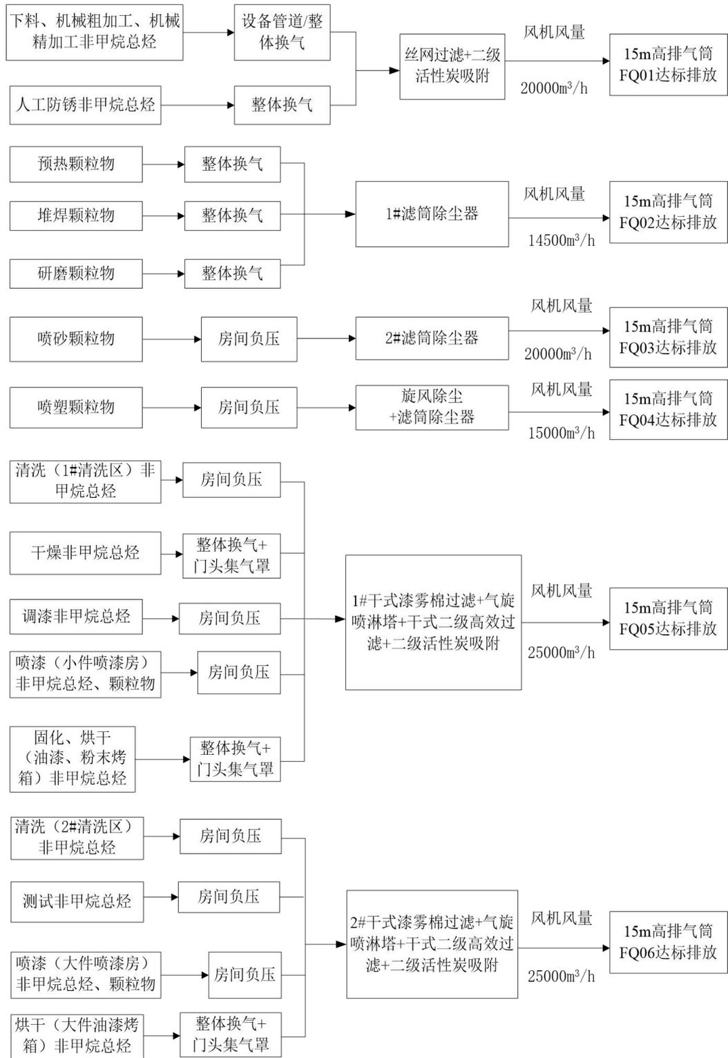
图 4-1 项目废气处理工艺流程图
